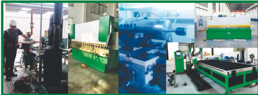
1. Corte en plasma CNC, Acero inoxidable 25 mm, acero al carbono 50 mm
